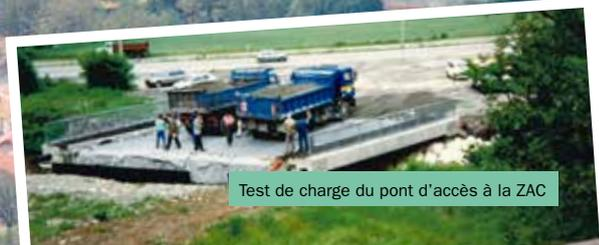
Test de charge du pont d'accès à la ZAC
